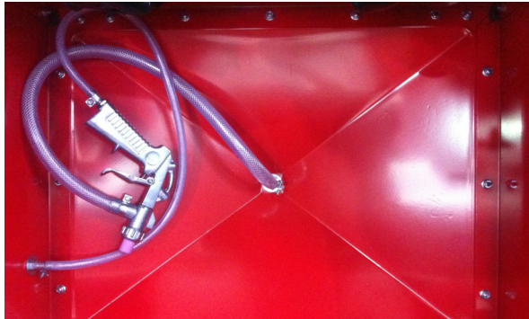
Abb. 6: Montage der Leitungen am Trichter
