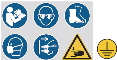
Abb. 1: Sicherheitskennzeichnungen an der Sandstrahlkabine
