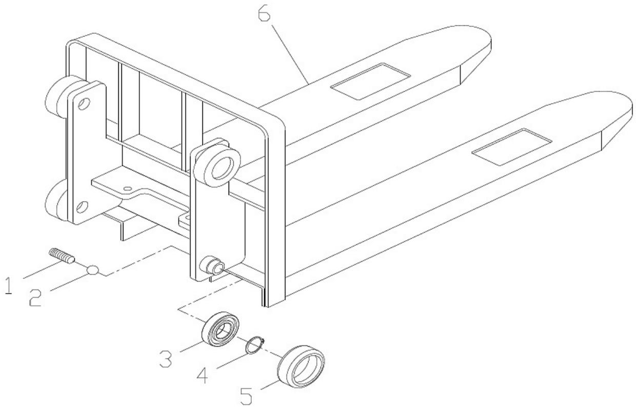
Abb./Fig. 7: Ersatzteilzeichnung 7 - GHHW 1000 / Spare parts drawing 7 - GHHW 1000
