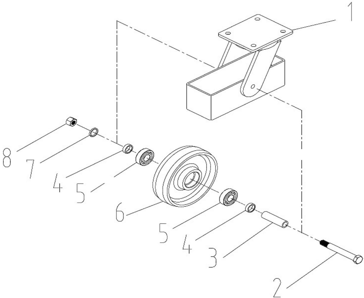
Abb./Fig. 1: Ersatzteilzeichnung 1 - GHHW 1000 / Spare parts drawing 1 - GHHW 1000
