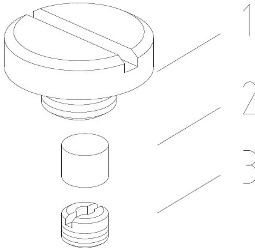
Abb./Fig. 5: Ersatzteilzeichnung 5 - GHHW 1000 / Spare parts drawing 5 - GHHW 1000
