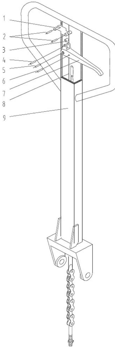
Abb./Fig. 2: Ersatzteilzeichnung 2 - GHHW 1000 / Spare parts drawing 2 - GHHW 1000
