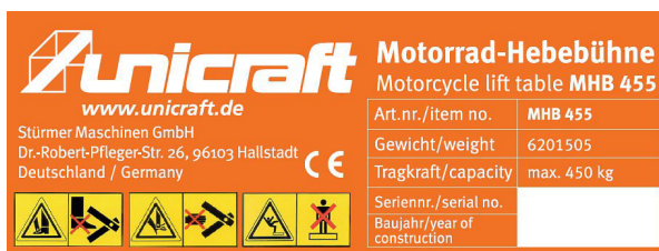
Abb. 2: Typenschild Motorrad-Hebebühne MHB 455
